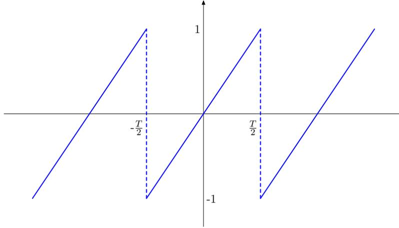
FIG. 3 – Signal en dents de scie : graphe de  $h$
